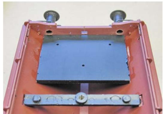
3. Jetzt verkleben Sie die drei dünneren Platten wie gezeigt. Setzen Sie dafür als Führung die Schrauben sowie den Halbrundniet ein.
