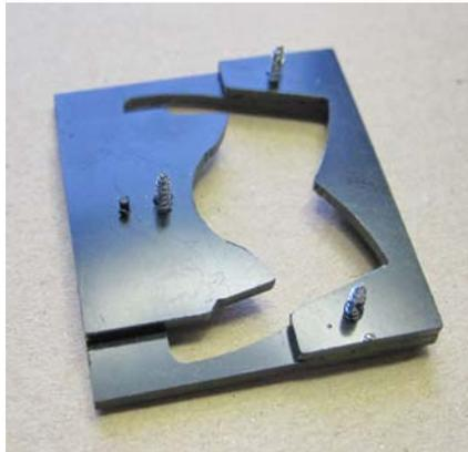
4. Nehmen Sie dazu Kunststoffkleber z.B. Pattex Plastic. Aufpassen das kein Kleber auf die Gleitbahn des Kupplungskopfes kommt.
