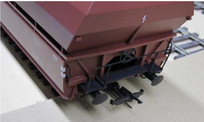
Die Prellplatte der Kupplung muss mit der Vorderseite der Puffer auf einer Höhe sein.
