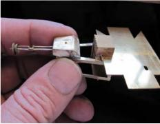
12. Jetzt setzen Sie den Baum probeweise ein. Zuerst ins angelötete Lager dann in das noch lose Lager welches Sie gleichzeitig in das Befestigungsloch stecken. Der Baum muss sich ganz leicht bewegen. Sonst nacharbeiten.
