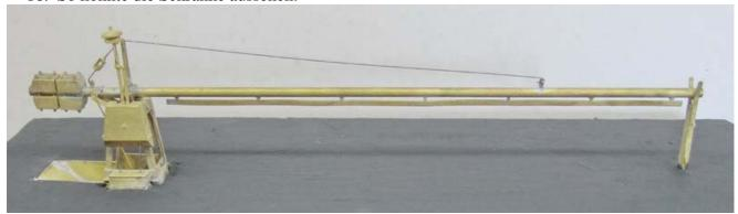
17. Jetzt zerlegen Sie alles und lackieren. Erst reinigen in Spüliwasser, besser: vorher leicht abstrahlen, trocknen lassen und dann grundieren. Den Baum lackieren Sie in weiß. Nach dem Durchtrocknen kleben Sie dann laut Zeichnung ab um die rote Farbe (RAL 3001) aufzubringen. Dann kleben Sie wieder den ganzen Baum ab und lackieren den Rest des Baumes sowie das Gestell in Resedagrün (RAL 6011) und mit Teerschwarz (RAL 9021) das Gegengewicht, die Schutzwanne sowie den unteren Bereich des Gestells.
