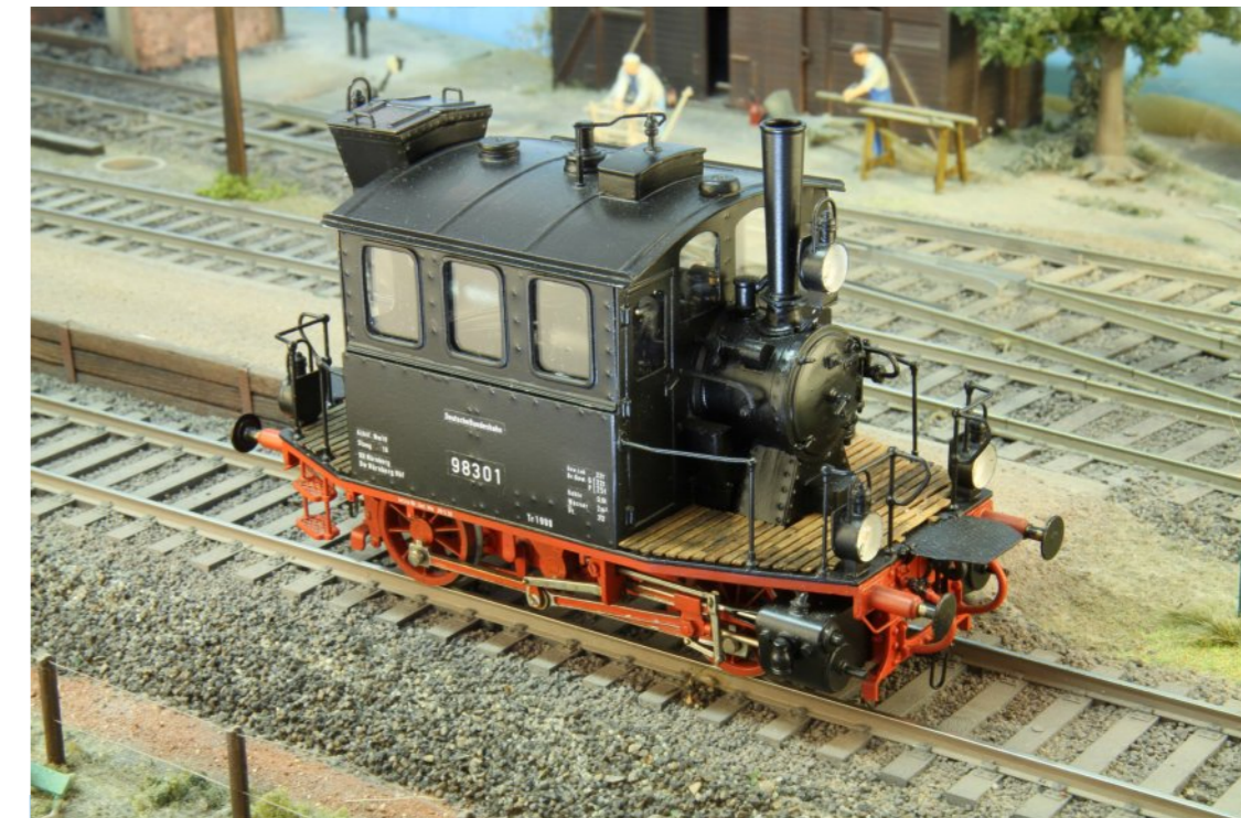
Baureihe 98, Glaskasten: Echtholzboden aus millimeterfeinen Leisten und komplette Inneneinrichtung fesseln den Blick des Betrachters. Viele Teile sind beweglich. Die Nietenreihen sind mit dem Näh-Rändelrad geprägt. Man hat pro Blech nur einen einzigen Versuch. Für den Bau des Glaskastens wurde extra eine spezielle Säge gebaut: Ein fest eingespannter Dremel wurde als Mini-Kreissäge umfunktioniert, um die feinen Leisten zu schneiden. Nur die Räder stammen von der Firma Heller, alles andere ist selbst gebaut.
