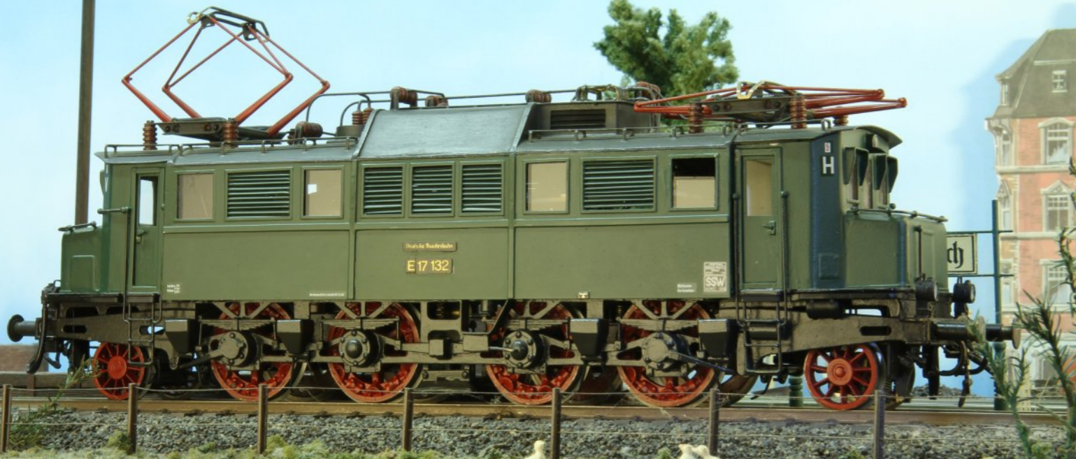
Oben: 1970 entstand das erste Modell, die E 17. Nur die Räder, Pantographen, Puffer und der Motor wurden gekauft, der Rest ist kompletter Eigenbau. Inklusiv der Lüfterblenden, die nicht geätzt, sondern einzeln geschnitten und verlötet sind. Im Laufe der Zeit wurde die Motorisierung dem aktuellen Stand der Motortechnik angepaßt. Eine Altbau-Ellok in mehrfacher Hinsicht, mit modernem Innenleben.
