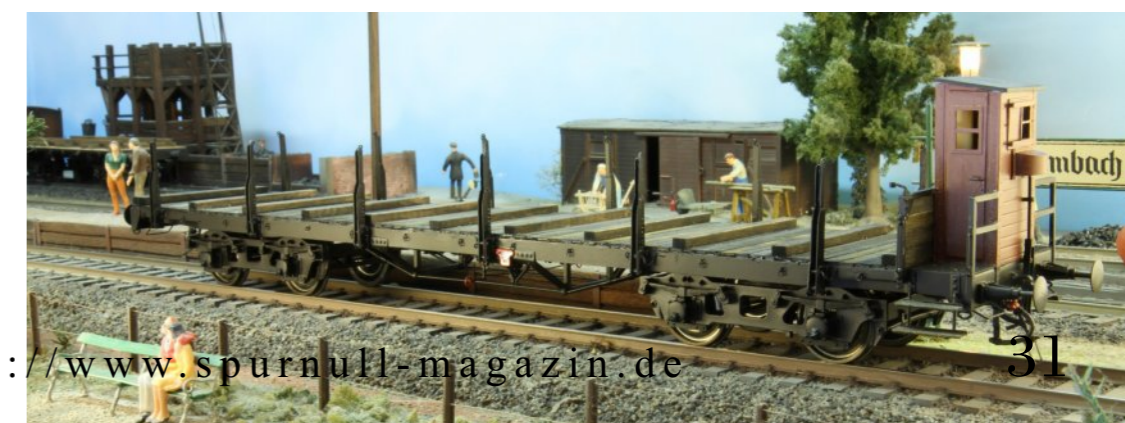
4-achsiger Flachwagen im Eigenbau. Vorlagen sind Fotos und Zeichnungen aus Modellbahnzeitschriften. Die millimetergroßen Bänder sind einzeln gebogen und eingefädelt.
