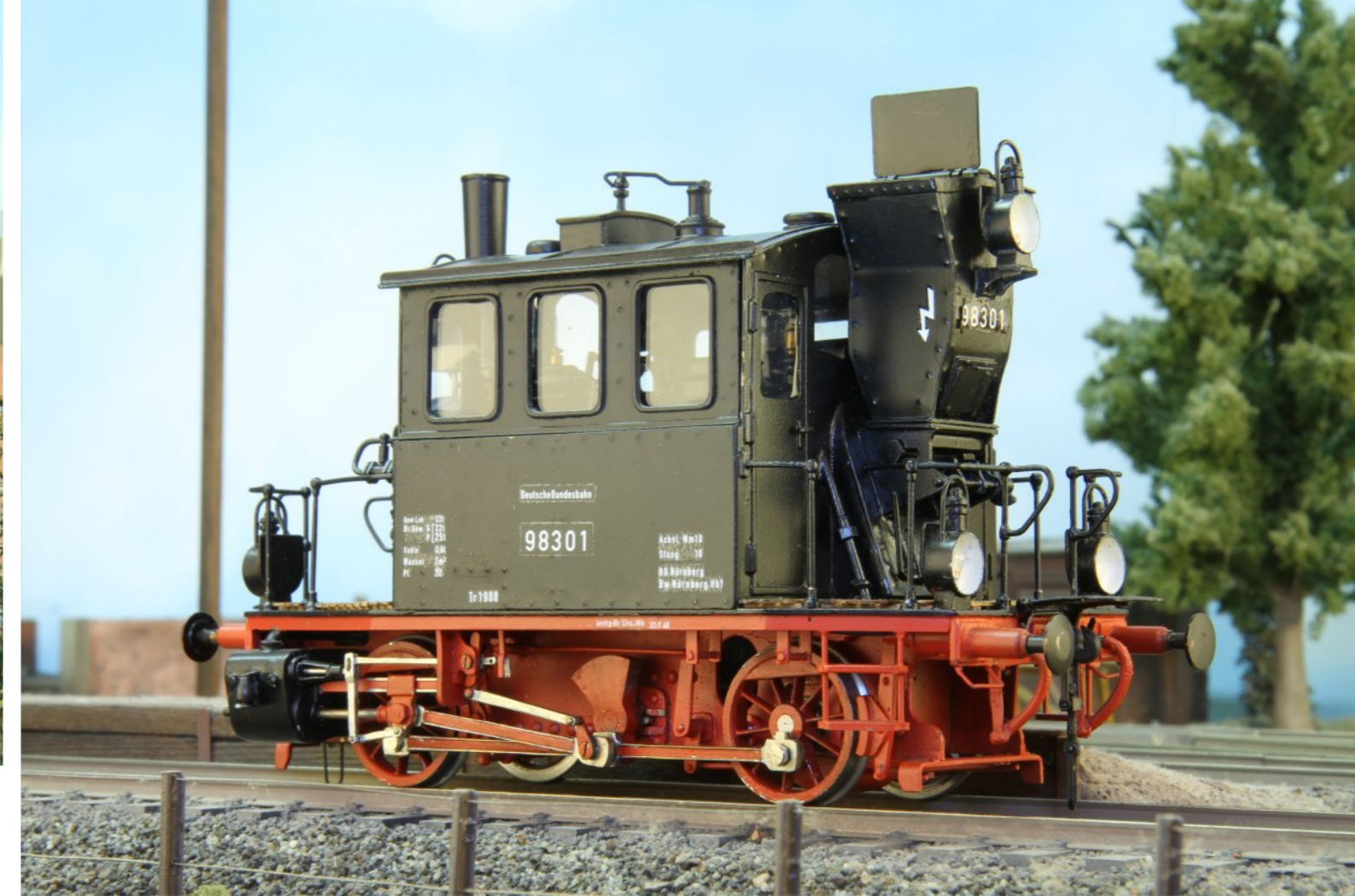
Baureihe 98, Glaskasten: Echtholzboden aus millimeterfeinen Leisten und komplette Inneneinrichtung fesseln den Blick des Betrachters. Viele Teile sind beweglich. Die Nietenreihen sind mit dem Näh-Rändelrad geprägt. Man hat pro Blech nur einen einzigen Versuch. Für den Bau des Glaskastens wurde extra eine spezielle Säge gebaut: Ein fest eingespannter Dremel wurde als Mini-Kreissäge umfunktioniert, um die feinen Leisten zu schneiden. Nur die Räder stammen von der Firma Heller, alles andere ist selbst gebaut.
